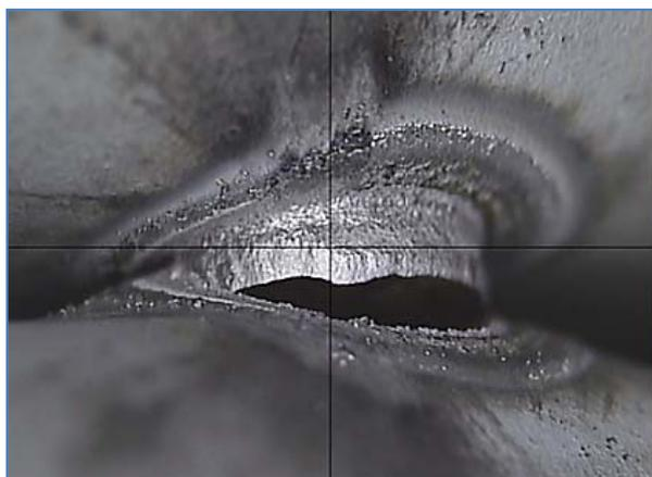
Рис. 8. Сварочная линза после растяжения
