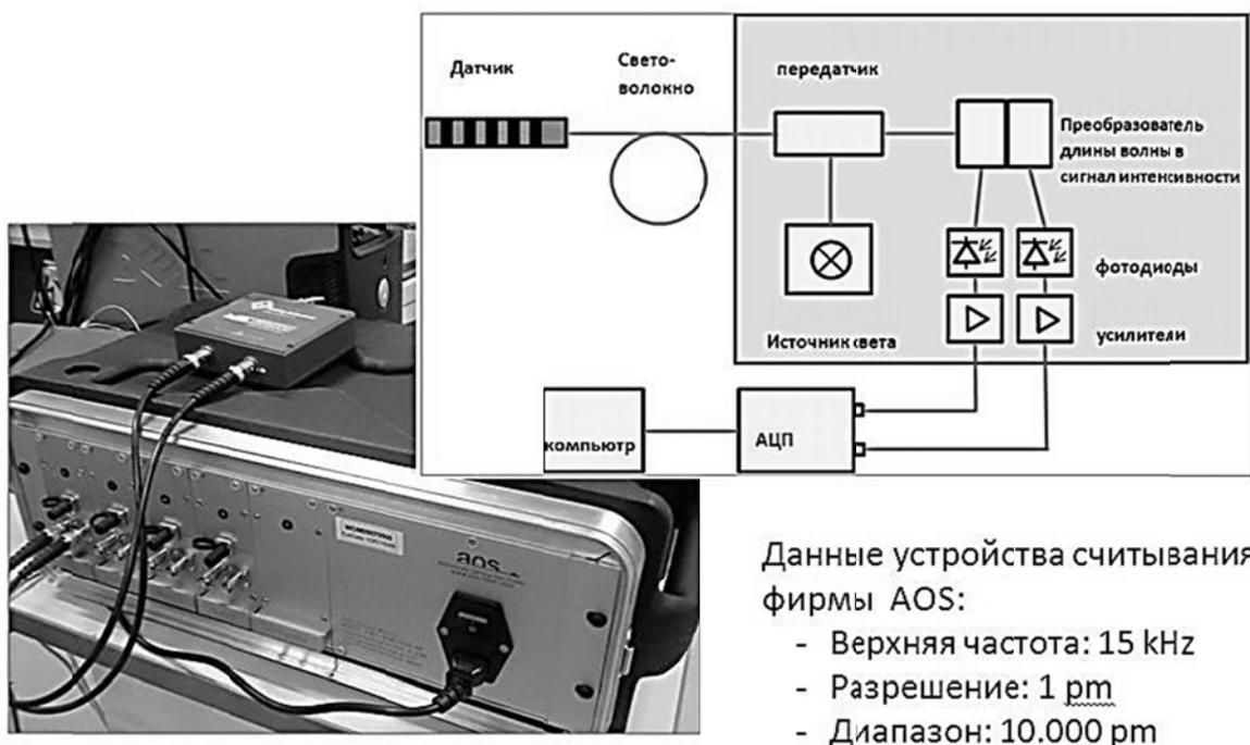
Рис. 4. Блок-схема системы считывания
